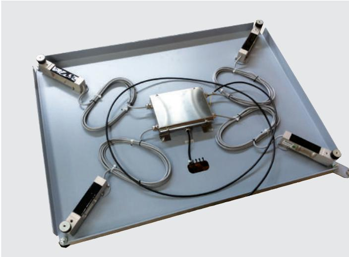
Structure de la balance avec 4 capteurs
