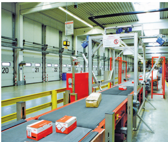
Trajet du colis avec balance et mesure de volume
