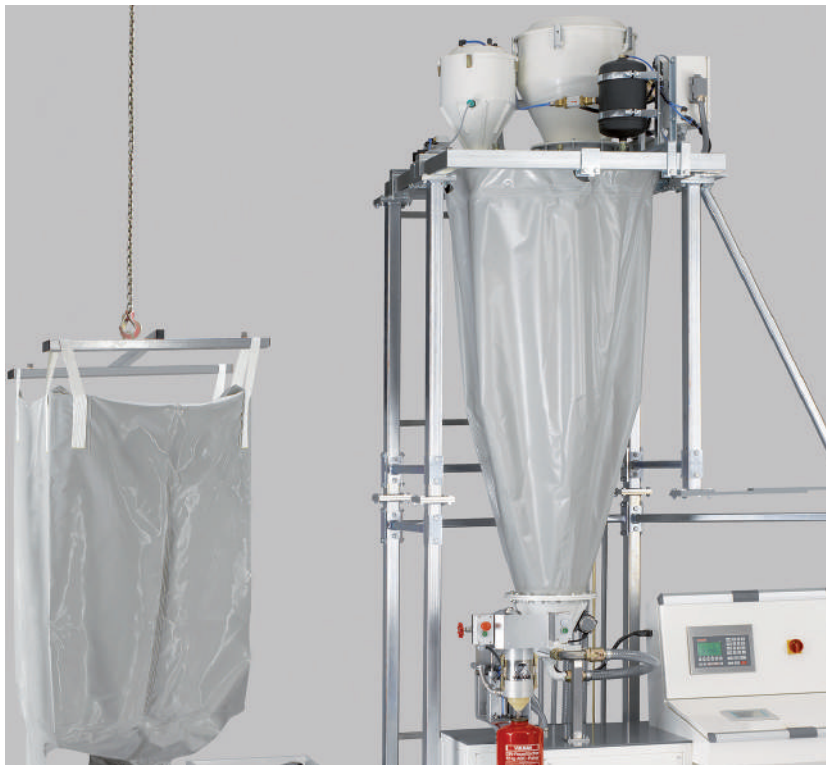
Installation complète de remplissage pour extincteur
